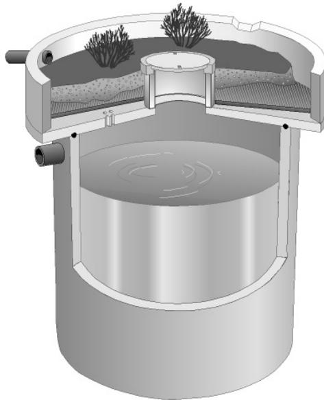
Abbildung 4: Gründachaufbau als belebte Bodenzone auf dem Zisternendeckel
