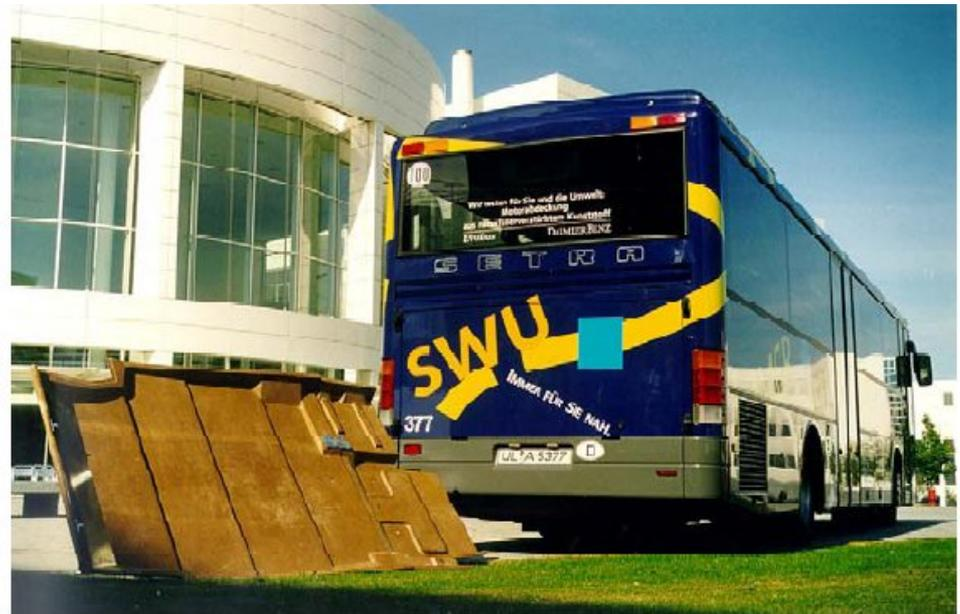
Bild 9: Naturfaserverstärkte Motorkapsel aus UP-Harz an einem Linienbus in Ulm
