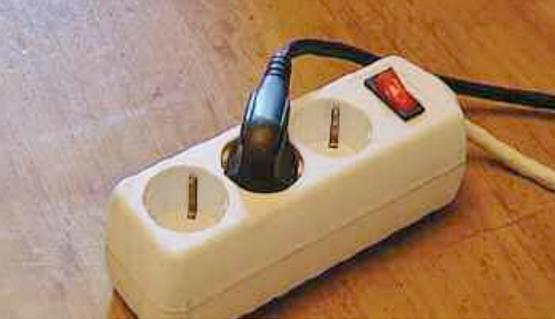
Solche abschaltbaren Steckerleisten können Geräte komplett vom Netz trennen
