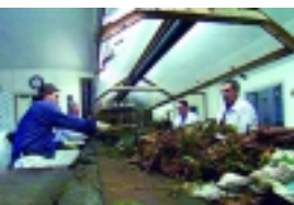
Im Kompostwerk in Mechernich werden Plastik- und Metallteile von Hand aussortiert
