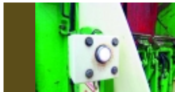
Bei falsch befüllten Tonnen leuchtet ein Warnlicht auf und ein Signal ertönt
