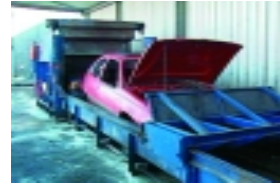
Die Karosserie wird mit allen Kunststoffteilen, die nicht verkauft oder recycelt werden sollen gepresst. So lässt sie sich leichter zum Schredderbetrieb transportieren
